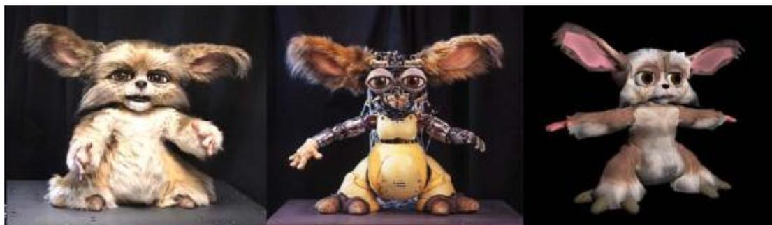
Abbildung 5.19: Leonardo: kosmetisch komplett (links), mit freigelegter Mechanik (Mitte) und das animierte Modell (rechts)
