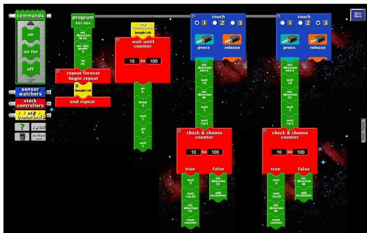
Abbildung 3.5: RCX-Code - graphische Programmierung für Lego Mindstorms
